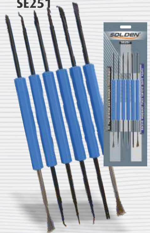
Escova: Limpeza antes da soldagem Raspador: Limpeza de excesso de solda e fluxo de solda. Faca: Corte de trilhas Gancho: Extrator de componentes e terminais Garfo: Decapagem Aguilha: Limpeza e raspagem.
