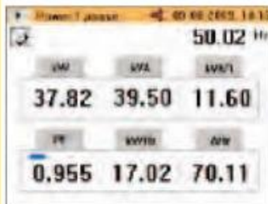
Medição do desempenho de equipamentos – esse consumo de carga equilibrada em sistemas mono e trifásicos.
